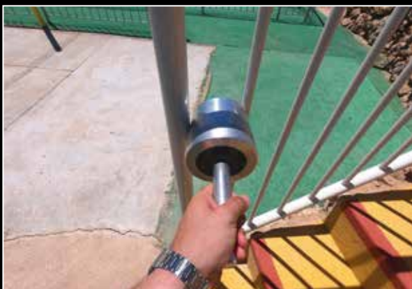
Comprobación de los requisitos de atrapamiento en una barandilla.
