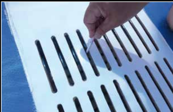
Medición de las rejillas de una piscina para evitar atrapamientos.
